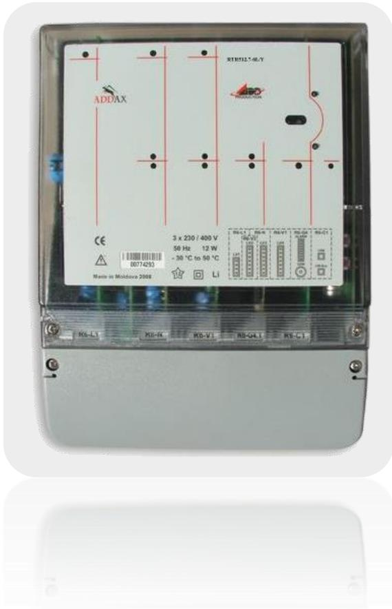
**Маршрутизатор (Роутер)** является устройством, входящим в состав оборудования автоматизированной системы учета электроэнергии и управления потреблением Smart IMS. Маршрутизатор обеспечивает транзит цифровых информационных потоков между Подсистемой сбора и передачи данных (ПСПД) и Центром Smart IMS. Каналы связи, которые используются при этом, отличаются друг от друга, как по физической организации, так и по используемым протоколам.
