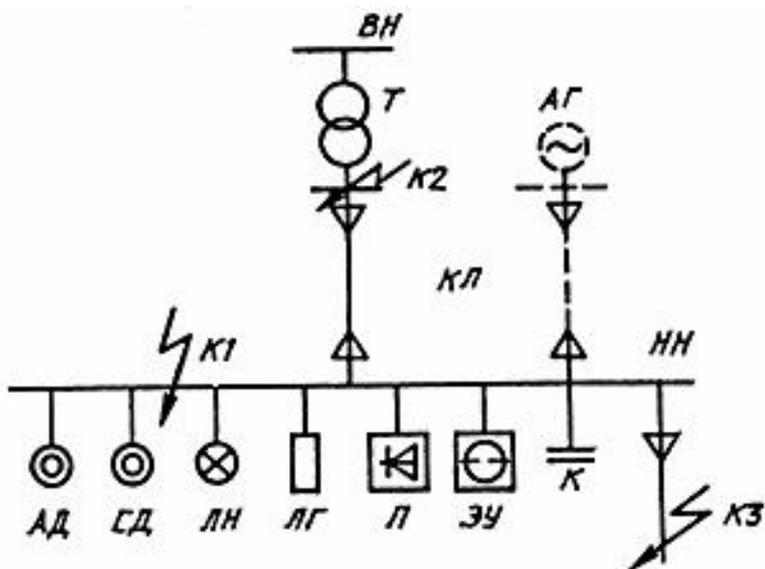
АД - асинхронные двигатели; СД - синхронные двигатели;
