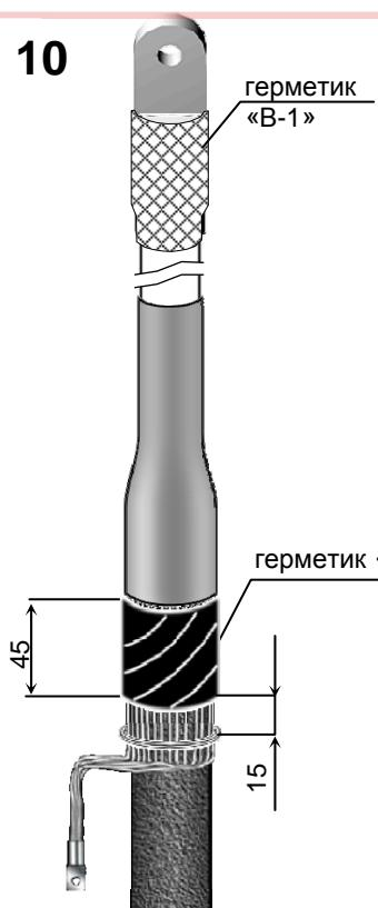
На медный проволочный экран у среза оболочки наложить ленту герметика «С» на длине 45 мм.
