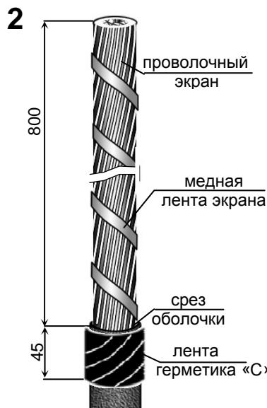
Удалить оболочку с конца кабеля до кольцевого надреза. Для облегчения снятия оболочки прогреть её пламенем горелки до температуры 50...70 °С.
