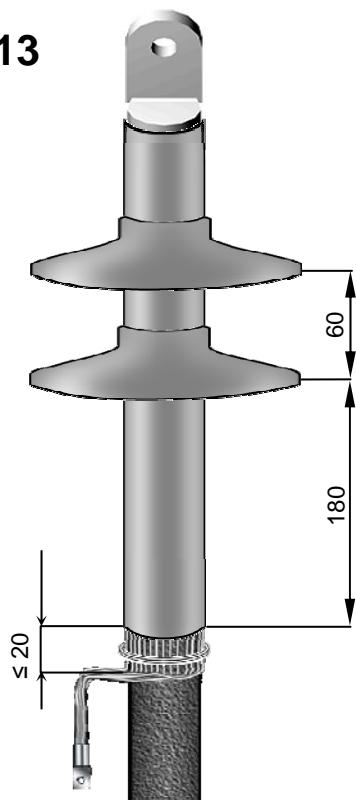
В случае концевой муфты наружной установки после усадки трекингстойкой трубы на неё надеть и усадить две термоусаживаемые «юбки» изоляторов, начиная снизу и на расстояниях, указанных на рисунке.
