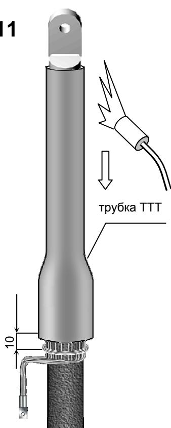
Надвинуть на конец кабеля трекингостойкую трубку (ТТТ) так, чтобы верхний конец её совпадал с краем цилиндрической части наконечника и усадить её, начиная с цилиндрической части наконечника.
