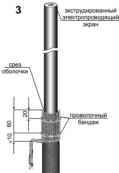
Отогнуть проволоки экрана кабеля на оболочку так, чтобы они не пересекались между собой, вдавив каждую в подмотку герметика «С». Проволоки экрана отгибать «с натягом», чтобы они плотно облегали срез оболочки кабеля.
