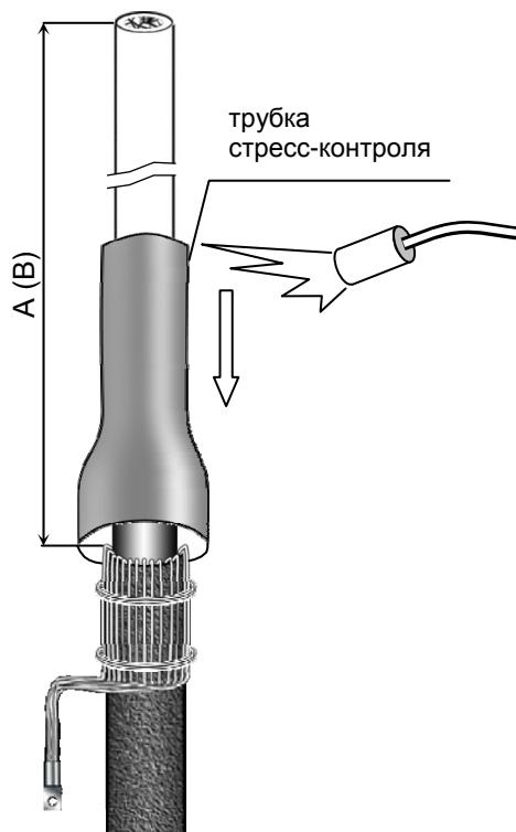
Надвинуть на жилу трубку стресс-контроля до упора в отогнутые проволоки медного экрана.
