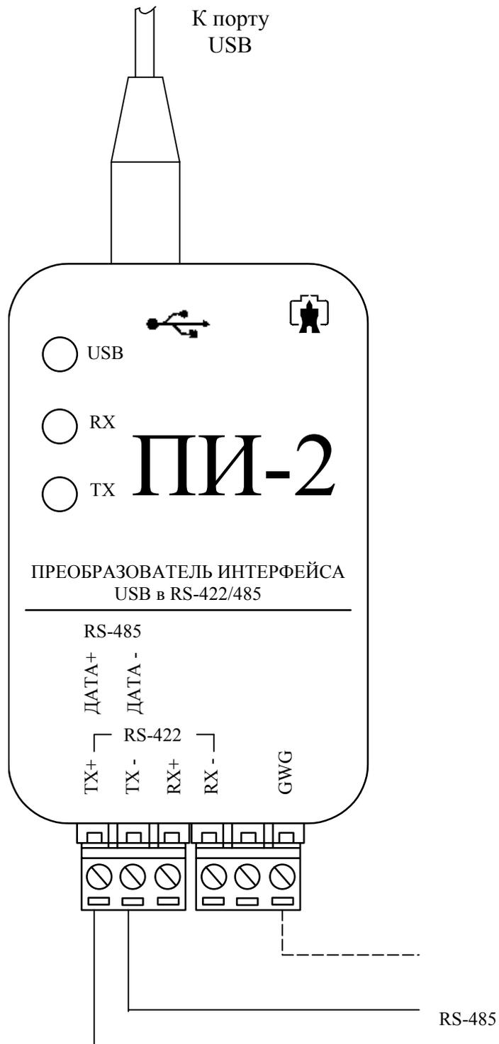
Рисунок 2 – Схема подключения ПИ-2 для канала RS-485
