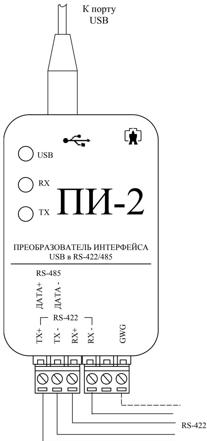
Цепь заземления блока питания «GWG» рекомендуется подключать к аналогичной цепи другого устройства.
