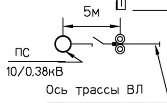
Промежуточная опора с кабельной муфтой ПцМ-2
