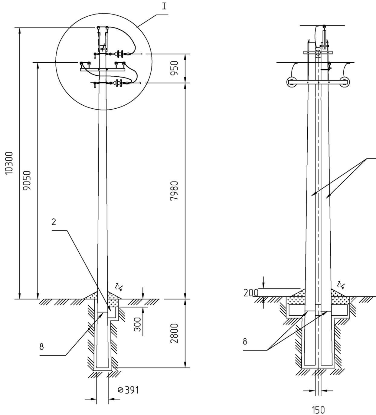
Схема установки опоры
