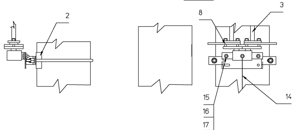
Установка кронштейна КЗ на опоре
