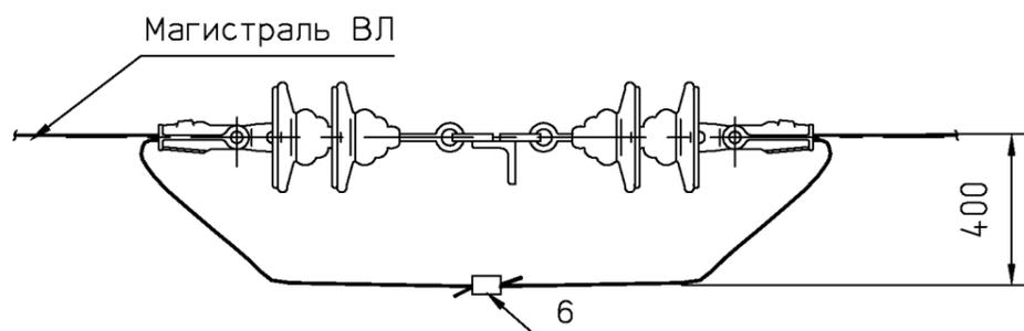
Зажимы (поз.6) для двойного и анкерного крепления проводов, для соединения проводов линейных ответвлений, для соединения проводов в петлях опор анкерного типа одного сечения (схемы 1,2,3) выбираются по табл.1
