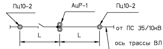
Концевая опора с разъединителем КцР-1
