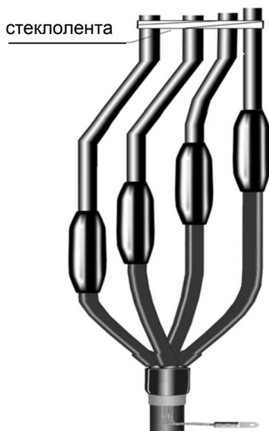
Надвинуть на каждую гильзу трубку для изоляции гильзы, установить её симметрично относительно гильз и усадить (рис.7). После усадки по торцам должен быть виден клей расплав.
