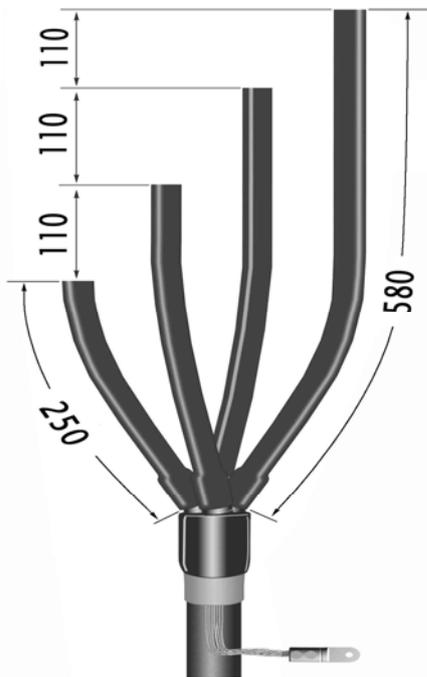
Ступенчато обрезать жилы кабеля отходящие от концевой муфты по рис.1 : нулевую жилу на расстоянии 250 мм от точки развода пальцев перчатки, остальные фазные жилы – ступенями, прибавляя к каждой фазе по отношению к предыдущей по 110 мм.
