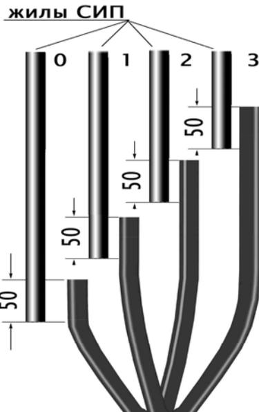
Распрямить концы проводов СИП на длине не менее 1000 мм, уложить их внахлест с жилами кабеля, расположив их в такой же последовательности : нулевую жилу СИП с нулевой жилой кабеля и т. д. Обрезать провода СИП на уровне концов жил кабеля.
