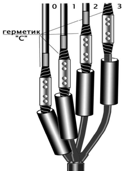
Обезжирить гильзы и прилегающие к ним участки изоляции на длине 50 мм. Обмотать эти участки лентой герметика «С» на длине 45 мм.
