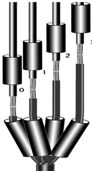
С концов каждой жилы проводов СИП и кабеля снять изоляцию на длине, равной половине длины гильзы. Притупить напильником торцы жил. Опилки тщательно удалить. Надеть на каждую жилу кабеля трубку для изоляции гильзы ТТШ (рис.3).
