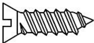
Рисунок 1 - Самонарезающий формующий винт (3.6.10)
