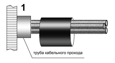
Надвинуть кабелей (кабеля) конец на полиэтиленовый упаковки пакет ОТ термоусаживаемой трубки уплотнителя для предотвращения возможности загрязнения внутренней поверхности трубки. Поверх полиэтиленового пакета надеть трубку уплотнителя. Сдвинуть трубку вдоль кабелей (кабеля).
