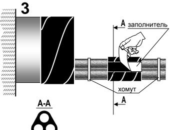
Протереть растворителем поверхность кабелей (кабеля) на расстоянии 100мм от края кабельного прохода на длине 100мм, протереть растворителем наружную поверхность трубы кабельного прохода на длине 100мм.
