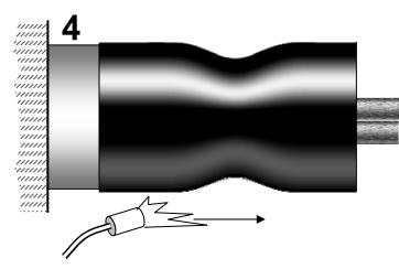
Трубку уплотнителя надвинуть на 120мм на трубу кабельного прохода (асбестоцементная труба) и усадить ее, начиная с кабельного прохода в направлении кабелей (кабеля).
