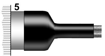
На этом монтаж уплотнителя кабельного прохода закончен, необходимо дать ему остыть перед продолжением работ по монтажу кабельной линии.
