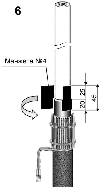
На переход (электропроводящий экран-полиэтиленовая изоляция кабеля) наложить манжету № 4 (из пакета 1ПКВ(Н)т10), длинной стороной по окружности кабеля с заходом на электропроводящий экран на 20 мм и на полиэтиленовую изоляцию на 25 мм, обжать рукой.
