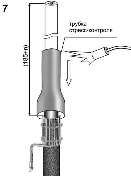
Надвинуть на жилу трубку стресс-контроля до упора в отогнутые проволоки медного экрана. Усадить трубку, начиная от конца жилы по направлению проволочного экрана.
