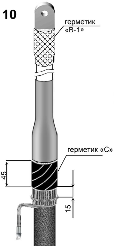
На медный проволочный экран у среза оболочки наложить ленту герметика «С» на длине 45 мм.
