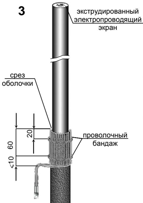
Отогнуть проволоки экрана кабеля на оболочку так, чтобы они не пересекались между собой, вдавив каждую в подмотку герметика «С». Проволоки экрана отгибать «с натягом», чтобы они плотно облегли срез оболочки кабеля. На расстоянии 20 и 60 мм от среза закрепить проволоки экрана бандажом из 3-4 витков медной проволоки. Проволоки медного экрана скрутить в жилу и оконцевать наконечником.
