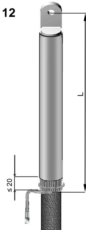
На этом монтаж концевой муфты внутренней установки закончен. Дать муфте остыть до температуры 40...50 °С, прежде чем подвергнуть её какому-либо механическому воздействию.
