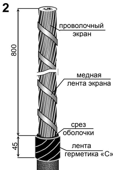
Удалить оболочку с конца кабеля до кольцевого надреза. Для облегчения снятия оболочки прогреть её пламенем горелки до температуры 50...70 °С. Удалить влагонабухающую бумагу по длине разделки. Отогнуть медную ленту экрана и аккуратно отрезать ее по линии среза оболочки кабеля. Салфеткой, смоченной в растворителе (бензине, уайтспирите), очистить оболочку кабеля на расстоянии 150 мм от среза. На оболочке кабеля от среза выполнить подмотку лентой герметика «С» на ширине 45 мм.
