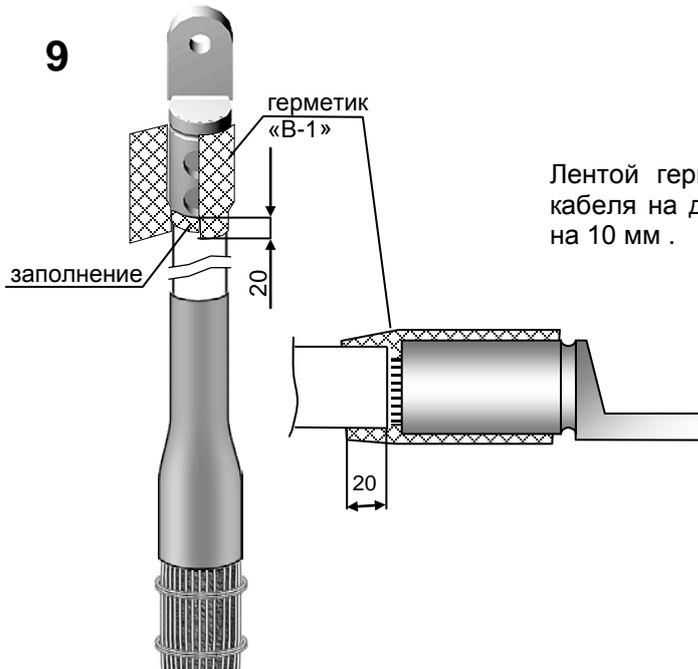
Лентой герметика В-1 обмотать наконечник и изоляцию кабеля на длине 20 мм. Ленту наматывать с перекрытием на 10 мм .
