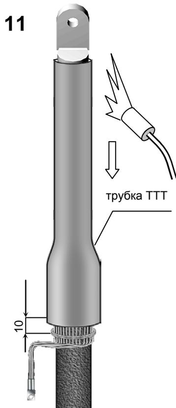
Надвинуть на конец кабеля трекингостойкую трубку (ТТТ) так, чтобы верхний конец её совпадал с краем цилиндрической части наконечника и усадить её, начиная с цилиндрической части наконечника.
