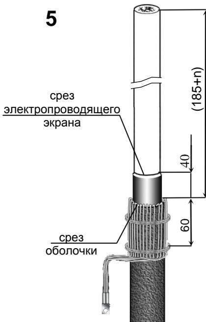
На конец кабеля надвинуть упорную шайбу, продвинув ее до среза оболочки, и с помощью специального инструмента (роликового ножа) снять электропроводящий экран с жилы кабеля, оставив участок экрана длиной 40 мм у среза оболочки кабеля.
