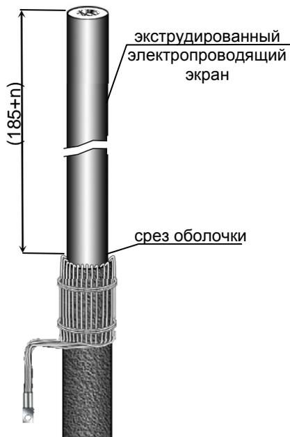
Размотать электропроводящую бумагу до среза оболочки, и аккуратно обрезать её **не повреждая электропроводящего экрана**.
