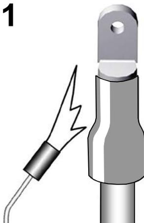
Обезжирить на каждой жиле цилиндрическую часть наконечника и трубку по жиле на длине 100 мм. Надвинуть на цилиндрическую часть наконечника трубку ТТнг для герметизации и усадить ее. После усадки по торцам трубок должен быть виден клей-расплав.
