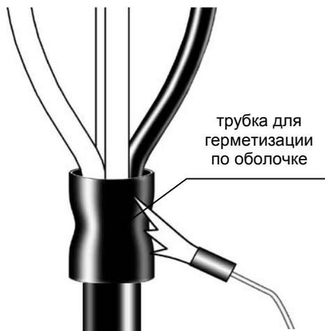
Очистить и обезжирить участок оболочки на длине 100 мм. На подготовленный участок оболочки сделать подмотку лентой №1 герметика «D» с небольшим перекрытием без натяжения (**рис.5а**).
