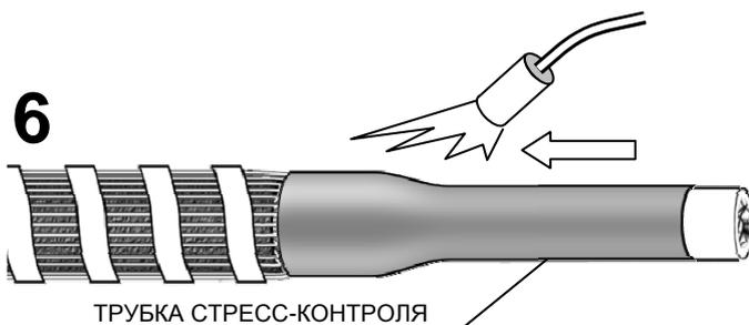
Надвинуть на жилу трубку стресс-контроля до упора в отогнутые медные проволоки экрана. Усадить трубку, начиная от конца жилы по направлению к проволочному экрану.
