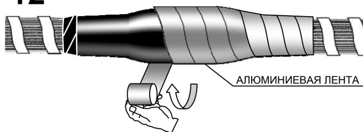
Поверх усаженной трубки ТТИЭ произвести подмотку алюминиевой лентой с перекрытием на 20 мм до упора в медные проволоки экранов кабелей, плотно обжав по всей длине муфты.
