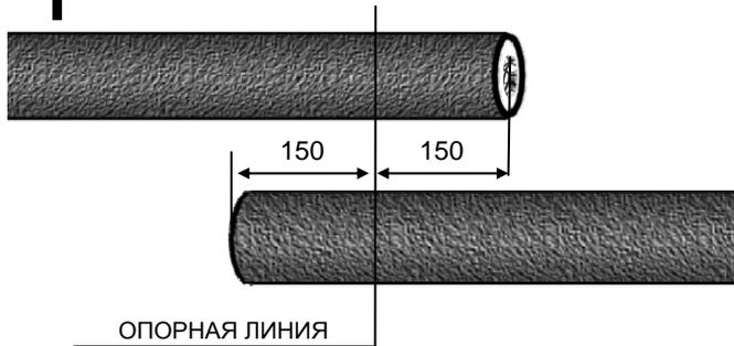
Распрямить концы соединяемых кабелей на длине не менее 1500 мм. Уложить внахлест в соответствии с указанными в таблице размерами. Отметить опорную линию.
