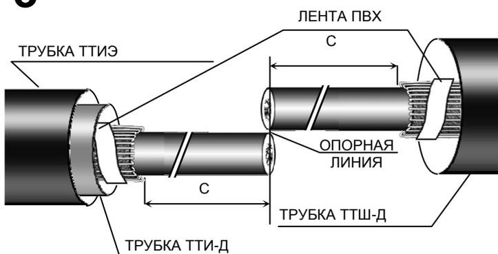
Отогнуть медные ленты экрана обоих кабелей и аккуратно обрезать по линии среза оболочки. Временно отогнуть проволоки экрана с конца каждого кабеля на оболочки кабелей. Проволоки экрана закрепить бандажом по всей длине из ленты ПВХ.
