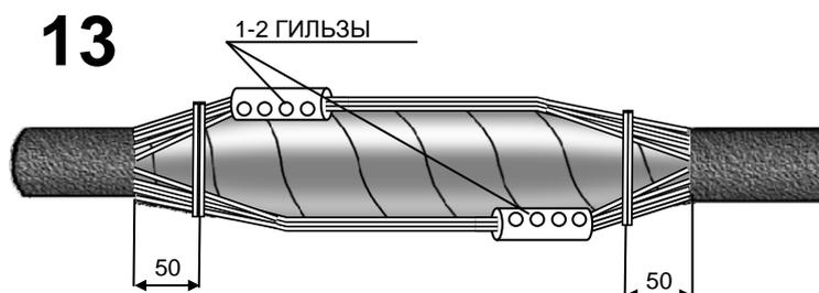
Снять временный бандаж из ленты ПВХ с проволочных экранов. Разогнуть проволоки экранов и расположить их параллельно друг другу по окружности муфты. Зафиксировать проволоки экрана бандажом из медной проволоки на расстоянии 50 мм от среза оболочки.
