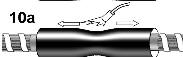
Надвинуть на гильзу изолирующую трубку (ТТИ-Д) так, чтобы она располагалась симметрично на соединительной гильзе. Задиры герметика при надвигании трубки не допускаются. Усадить трубку, начиная с середины, далее в обе стороны. Затем на неё надвинуть изолирующую экранированную трубку (ТТИЭ), установить её так, чтобы она располагалась между проволочными экранами кабелей. Усадить трубку, начиная с середины, далее в обе стороны.
