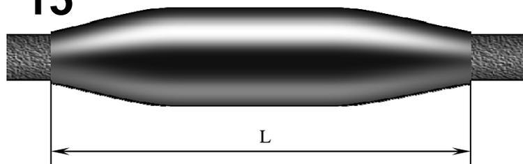
Надвинуть на муфту трубку-защитный кожух (ТТШ-Д), установить её симметрично относительно центра муфты и усадить, начиная с середины, далее в обе стороны.
