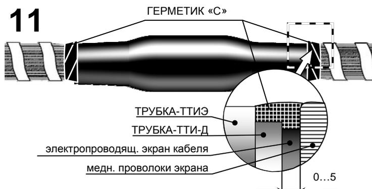
Ленту герметика «С» № 1 сложить вдвое по длине и заполнить ей промежуток между усаженными трубками и проволоками экрана. Заполнение выполнять с натягом. Лишнюю ленту герметика удалить.
