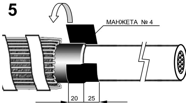
На переход (электропроводящий экран – полиэтиленовая изоляция кабеля) наложить манжету № 4 (из комплекта манжет 1ПСт10) черного цвета длинной стороной по окружности кабеля с заходом на электропроводящий экран на 20 мм и на полиэтиленовую изоляцию на 25 мм, обжать рукой.
