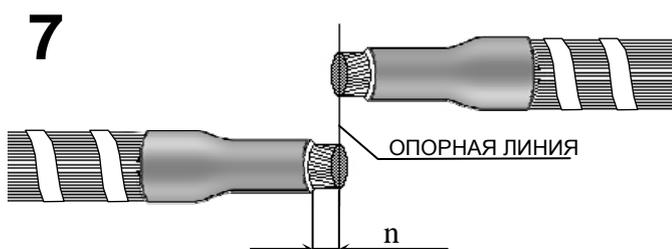
Снять изоляцию с конца каждой жилы соединяемых кабелей снять изоляцию на длине (n).
