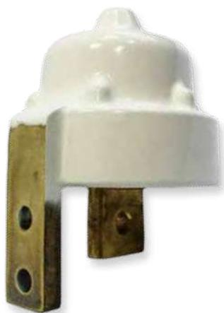
Искровой промежуток (ИП) серии CLS предназначен для защиты элементов опор или конструкций контактной сети (контактного провода или рельса) от протекания по ним блуждающих токов, а также для пропуска тока в рельсовую цепь при перекрытии или пробое изоляции контактной сети или высоковольтной линии электропередачи продольного электроснабжения, проходящего по опорам контактной сети.
